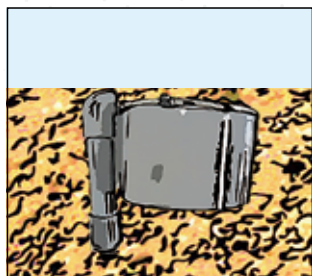
●内筒周囲にワイヤーをかけ、外筒に被せます。
